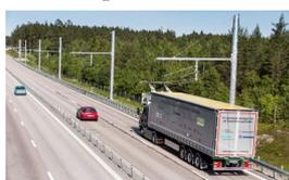
che hanno un attrezzatura speciale. Infatti, qua centrano i camion dotati di pantografi che potranno ricevere l'energia e connettersi e disconnettersi grazie a un sistema di telaio e catenarie. Così potranno lasciare la via speciale per tornare al loro sistema iniziale : motore a combustione o motore elettrico. Questa nuova tecnologia resa possibile grazie al gruppo SCANIA, costruttore di camion elettrici si
